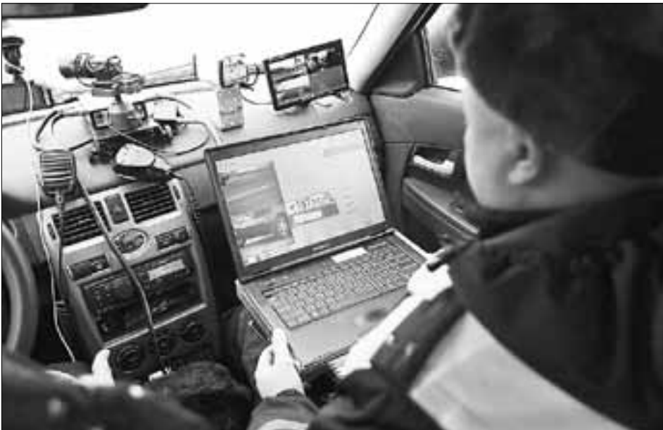
■ Комплекс «Автоураган» автоматически распознает номера машин нарушителей
