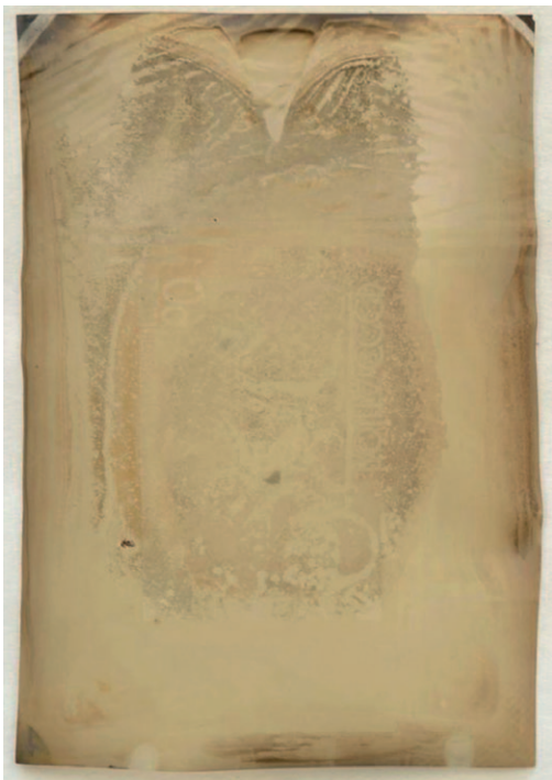
Ил. 16. Выцветание изображения негатива на нитроцеллюлозной основе
