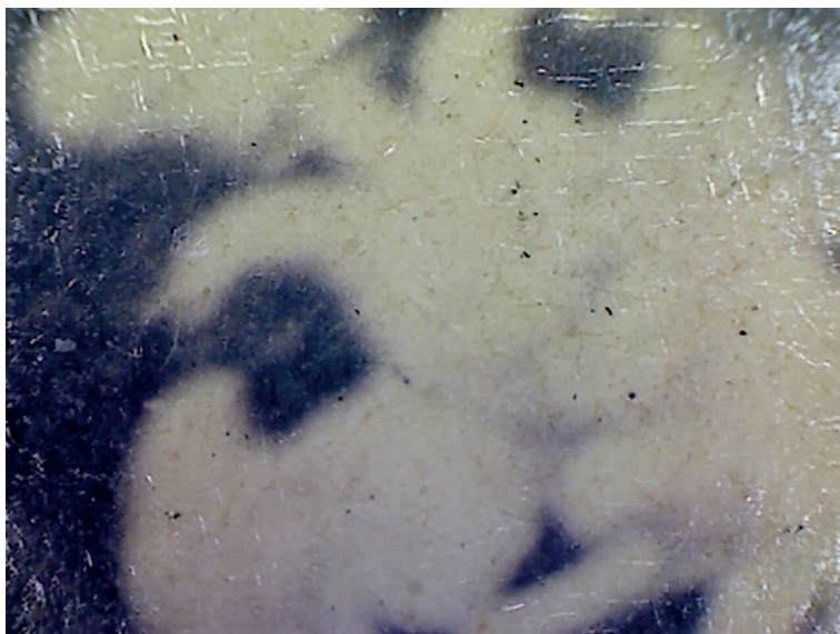
Ил. 10. ФФ 7/789. Волокна бумаги, включения и пятна. Увеличение в 200 x
