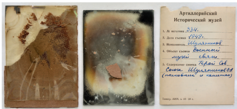
Ил. 17. Выцветание изображения негатива на нитроцеллюлозной основе и разрушение бумажного конверта под действием выделяющейся кислоты
