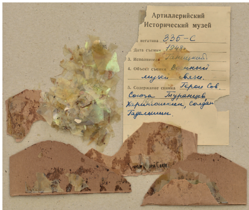
Ил. 15. Химико-фотографические дефекты. Разрушение основы негатива на нитроцеллюлозной основе
