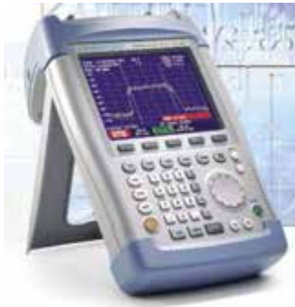
Figure 37: The Handheld Spectrum Analyser R&S FSH (Rohde und Schwarz)
