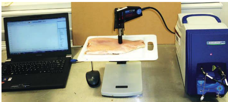
Ramanův spektrometr pro nedestruktivní analýzu kvality masa ryb.
