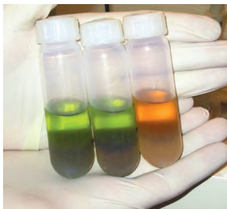
Extrakce tuku ze vzorků planktonu (vlevo) a metylestery mastných kyselin (FAME) připravené pro analýzu plynovou chromatografií (GC).
