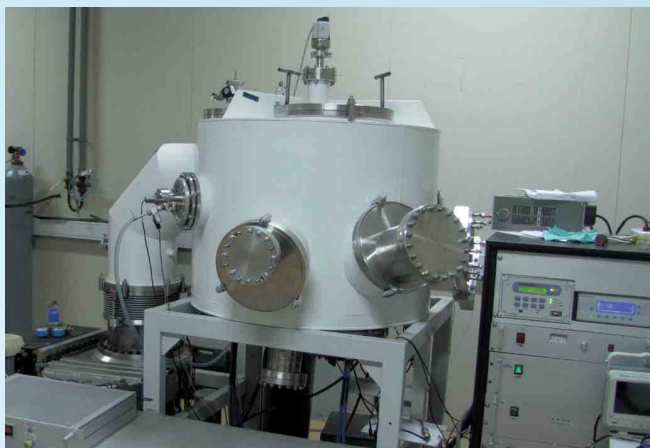
Установка для напыления многослойных тонкопленочных структур. Полигон для разработки перспективных технологий. Имеет 4 магнетронных и 2 ионно-пучковых распылителя с возможностью ионной полировки растущих пленок. Прямого аналога нет
