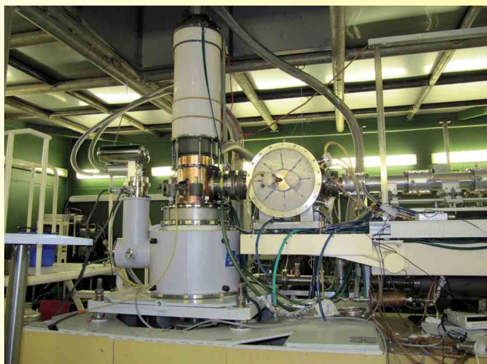
Мегаваттный гиротрон производства ИПФ/ГИКОМ на испытательном стенде Курчатовского института (разработан для ИТЭР)
