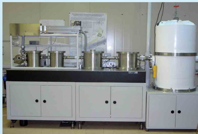
Рефлектометр на основе лазерно-плазменного источника мягкого рентгеновского излучения для изучения элементов рентгенооптики и спектроскопии твердого тела. По основным техническим характеристикам существенно превосходит мировые аналоги и по своим возможностям приближается к синхротронам 1–2-го поколения
