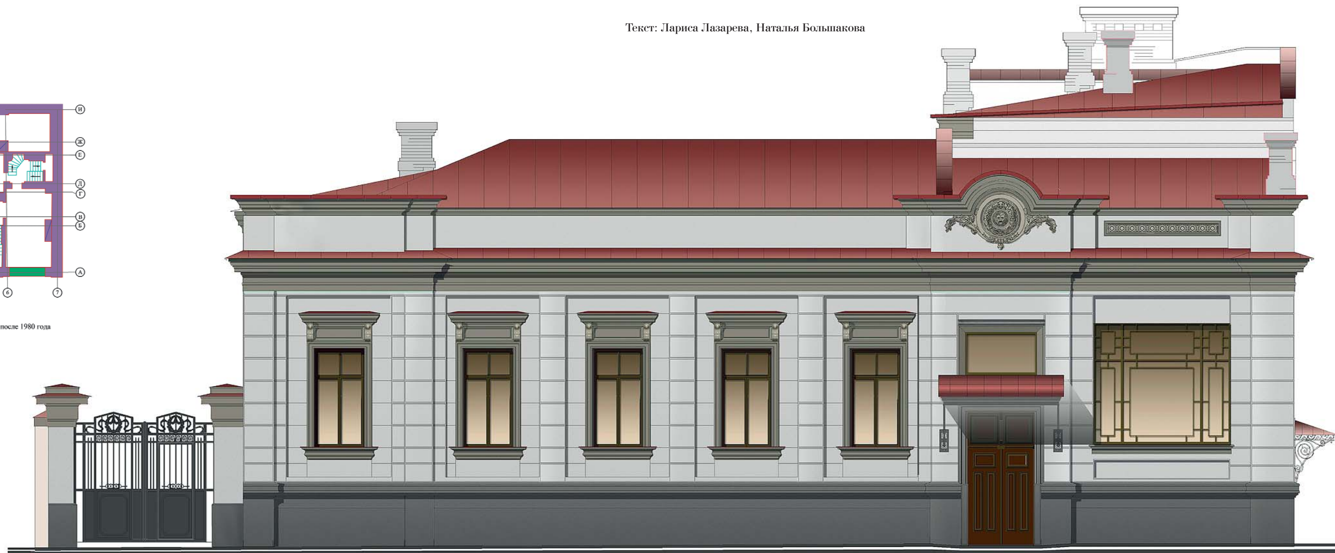
Историческая периодизация. 1 этаж Правее: Главный фасад. Проектное предложение после раскрытий
