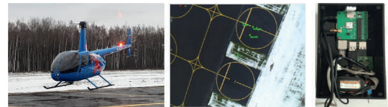
Проведение лётных испытаний системы позиционирования летательного аппарата (слева) относительно взлётно-посадочной площадки (в центре). Справа - устройство для позиционирования летательного аппарата относительно взлётно-посадочной площадки.
