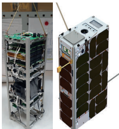
Спутник Московского университета «Монитор-1», запущенный 9 августа 2022 г. (слева). КА «Авион» – один из кубсатов, запланированных к запуску в 2023 г. (справа).
