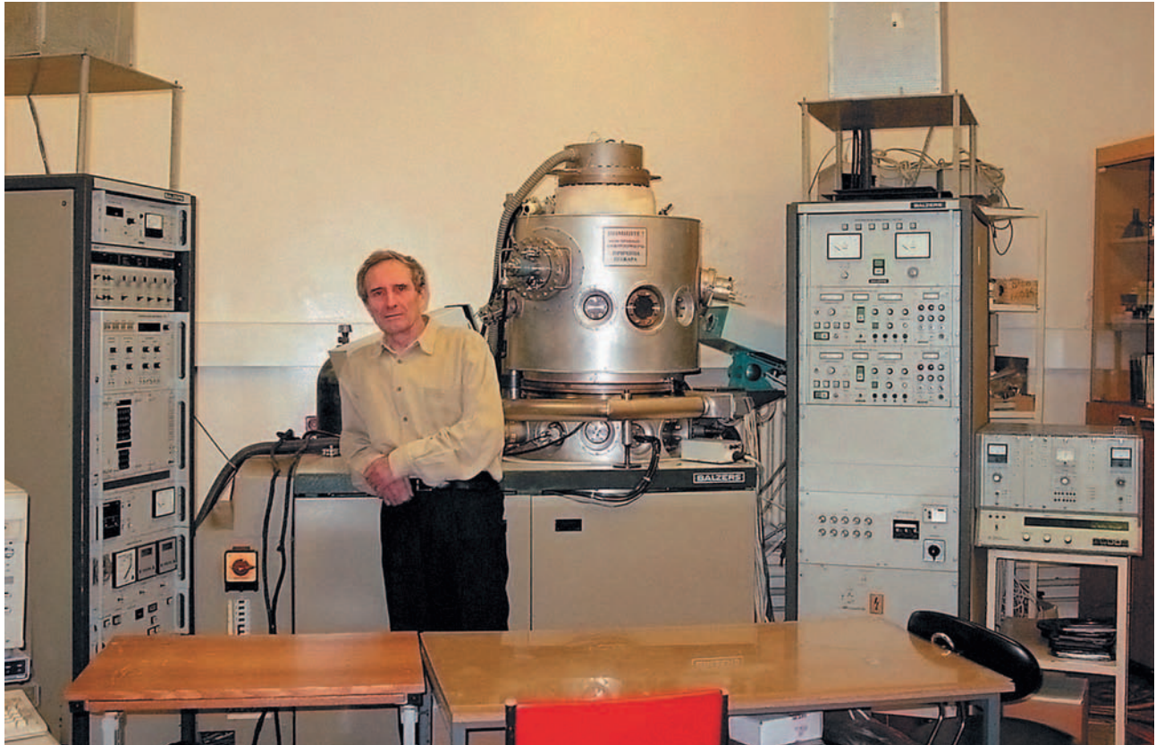
Установка для магнетронного распыления веществ. Д.ф.м.н. Э.И. Рау.
