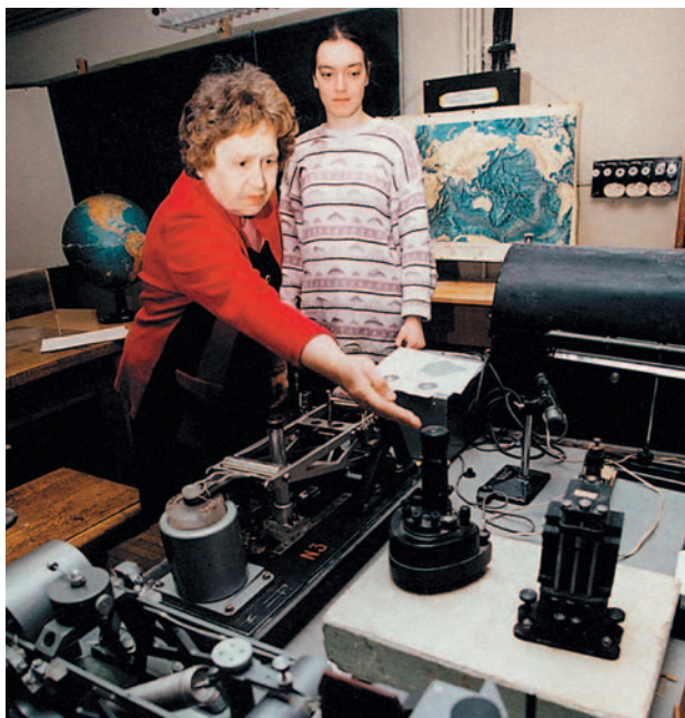
Установка для выполнения задачи по физическому моделированию сейсмических волн. Руководитель спецпрактикума с.н.с. Т.А. Проскурякова.
