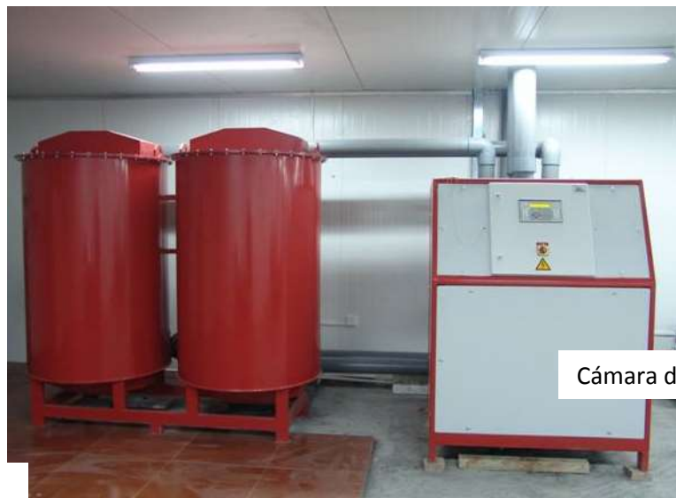
Figura 8. Filtro de cal para absorber CO 2 de la cámara de AC. (Fuente: Cerón-Carrillo y Rodríguez-Martínez, 2007)
