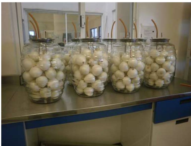
Figura 15. Frascos utilizados como cámaras herméticas para almacenar cebolla en AC
