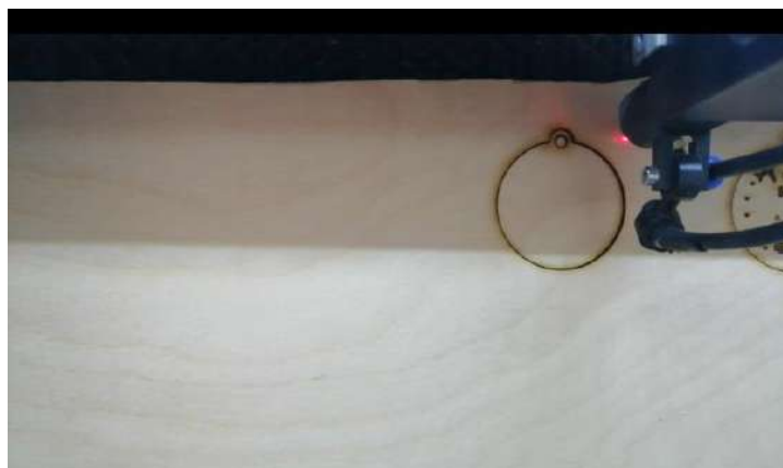
Рис. 6. Изготовление основания брелка
