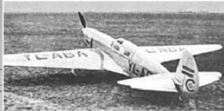
С-6 (1935). Данные самолета: размах крыльев, м 11.00; площадь крыла, м 2 12.80; масса макс.кг взлетная 1150; мощность двигателя, л.с. 130; скорость макс., км/ч 300;
