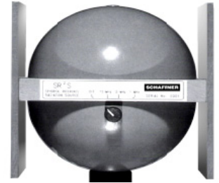
Сферический эталонный источник излучения «KSQ 1000»
