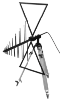
Классическая антенна «BiLog®», модель «CBL 6111»
