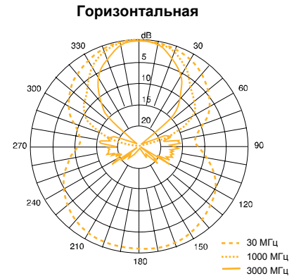
«CBL 6143», типичные диаграммы направленности в полярных координатах
