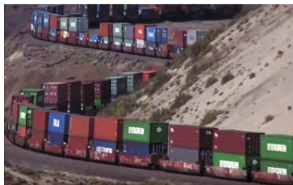
Рис. 3. Фрагмент контейнерного поезда с двухъярусной погрузкой контейнеров
