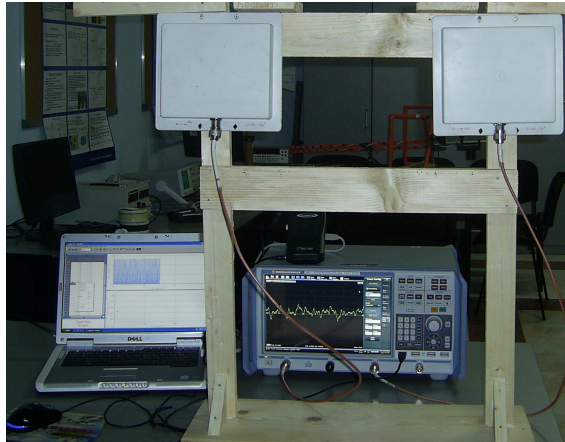
Figura 2.2.1. Elementele sistemului de testarea cu unda continua
