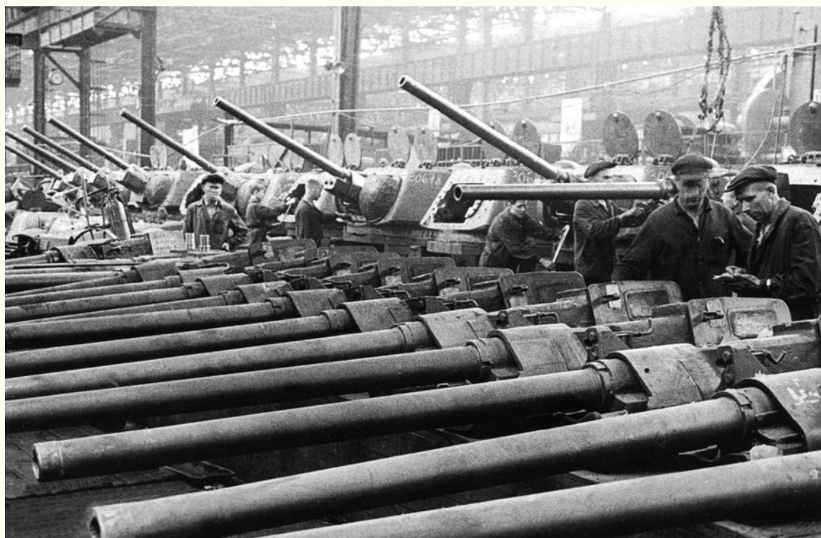
Производство танков Т-34-76. На переднем плане 76,2-мм пушки. Челябинский Кировский завод, 1943 год
