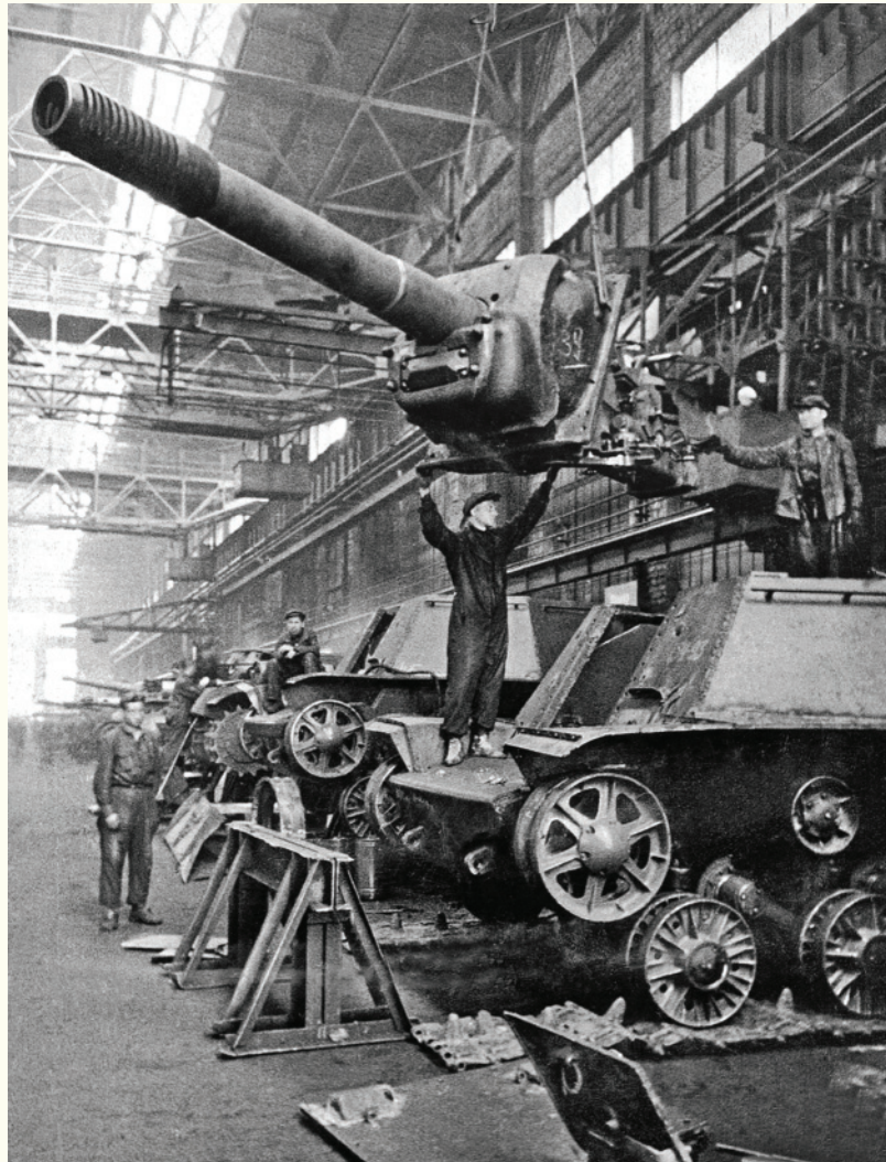
Сборка СУ-152: монтаж гаубицы-пушки МЛ-20С. Челябинский Кировский завод, 1943 год
