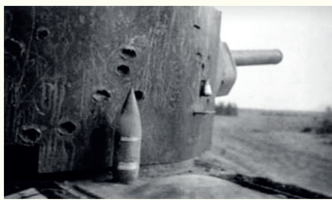
Следы от попадания снарядов на башне КВ-2
