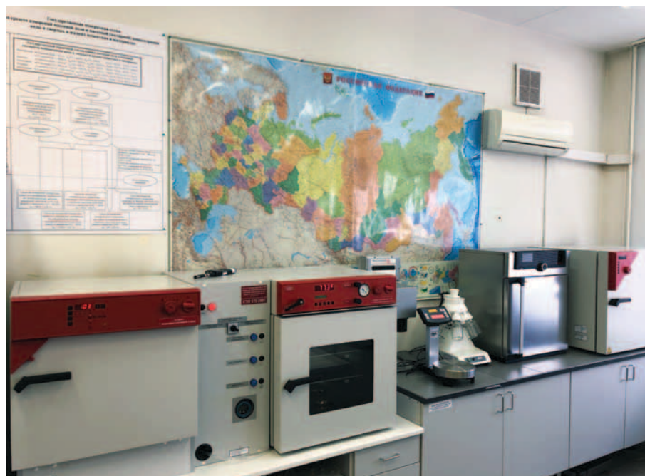
Государственный первичный эталон единиц массовой доли, массовой (молярной) концентрации воды в твердых и жидких веществах и материалах
