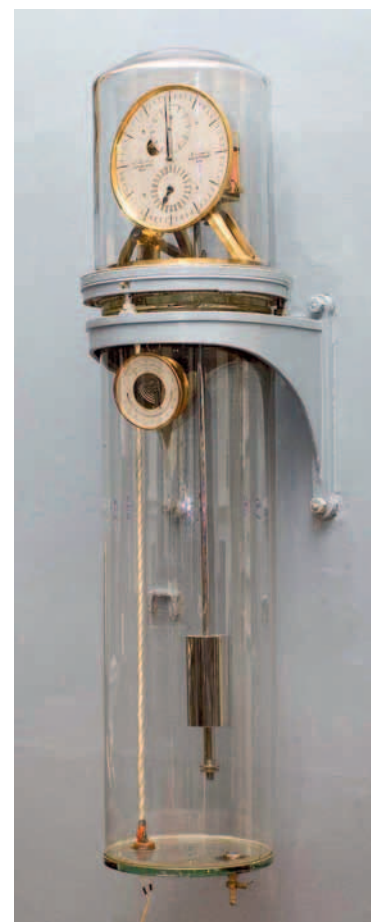
Часы фирмы «Рифлер». Входили в состав группового эталона единицы времени — секунды с 1903 до 1950-х гг. Экспозиция Метрологического музея
