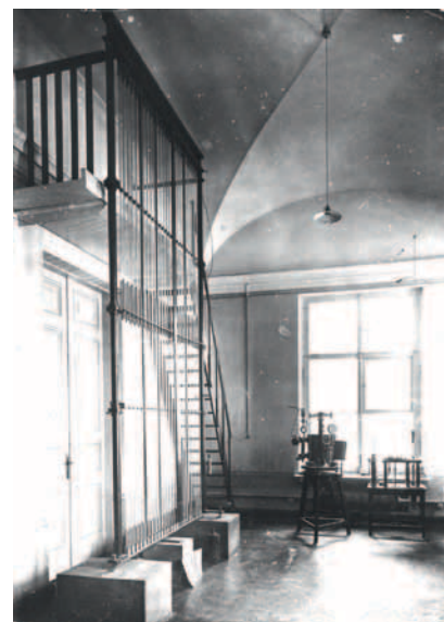
Первый эталон единицы давления — ртутно-водяной манометр конструкции Д. И. Менделеева, 1906 г.
