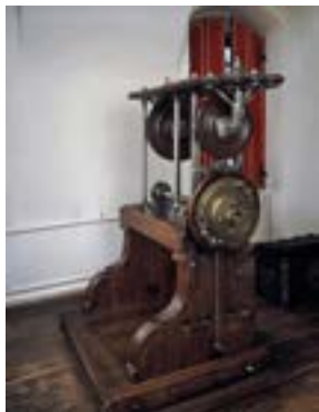
Рис. 2. А.К. Нартов. Токарно-копировальный станок. Первая половина XVIII века
