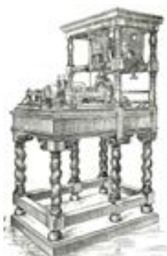
Рис.5. А.К. Нартов. Токарно-копировальный станок. Первая половина XVIII века
