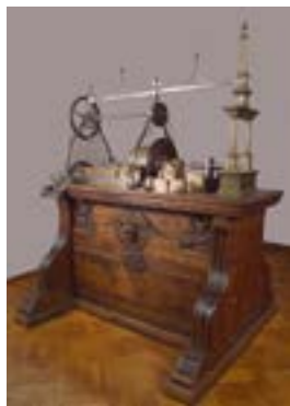
Рис. 6. А.К. Нартов. Большой токарно-копировальный станок. Первая половина XVIII века
