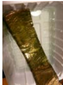
Рис. 8. Замачивание полосы с бортов оклада в растворе Трилон Б
