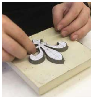
Илл. 8. Процесс лепки модели изразца с лилией по реконструированному лекалу. Фото автора, 2019
