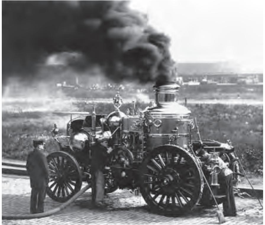
Подготовка парового пожарного насоса.
