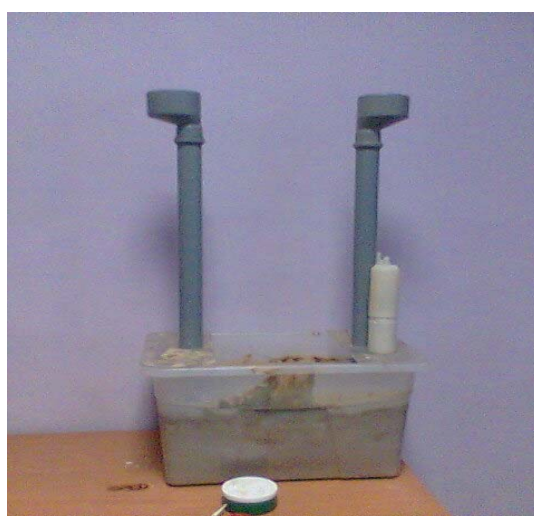
Рис. 3. Лабораторная установка для проведения экспериментов по скважинному выщелачиванию
