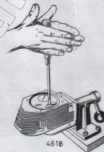
Bild 52 Ventil einschleifen
