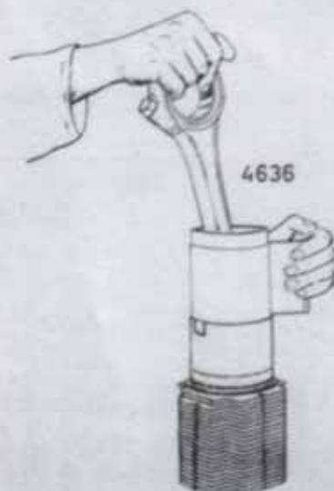
Bild 70 Einführen des Kolbens in den Zylinder
