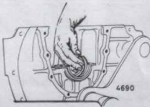
Bild 81 Einsetzen der bundlosen Lagerschalen
