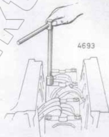
Bild 89 Handfest-Anziehen der Lagerschrauben mit Steckchlüssel
