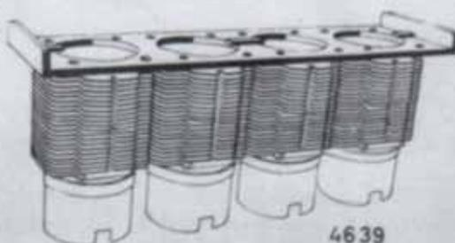
Bild 73 Vorrichtung zur Halterung der Zylinder auf dem Kurbelgehäuse
