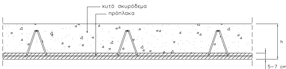
Σχήμα 2. Εγκάρσια τομή πρόπλακας με χυτό επιτόπου σκυρόδεμα
