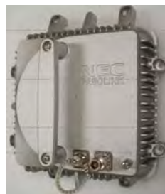
Рисунок 5.2 ODU, работающий в диапазоне 13 – 38 ГГц, и монтируемая напрямую антенна диаметром 0,3 м – Рисунок 5.3 ODU, работающий в диапазоне 6 – 11 ГГц
