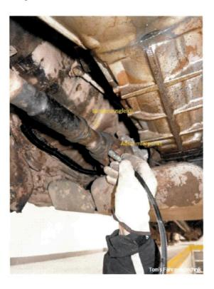
Punkt 2: Hier so viel Fett einspritzen, bis es an den Ringen austritt. Wenn man an den Abschmierpunkt nicht gut herankommt, kann man die Kardanwelle per Hand in Position drehen. WICHTIG: Man kann die Kardanwelle nur dann mit der Hand drehen, wenn die Freilaufnaben raus sind (4x2).
