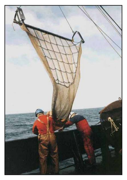
Figure 6.3.1.1.1. 2m beam trawl.
