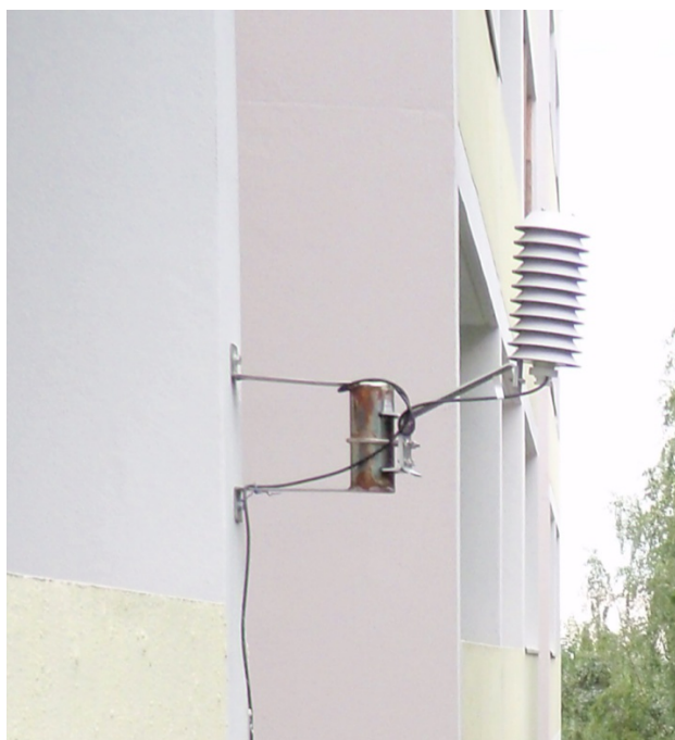
Kuva 4.9. Ulkoilman RH/T-anturi kiinnitettiin parvekkeen pieliseinään ja suojattiin auringon säteilyltä ja sadevedeltä erillisellä tehdasvalmisteisella ulkoanturisuojuksella.
