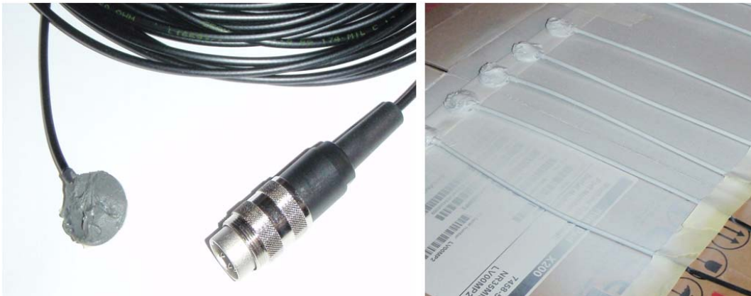
Kuva 4.8. Lopuksi anturien ulkopinnat ja noin 20 cm anturin johtoa maalattiin valkoiseksi.
