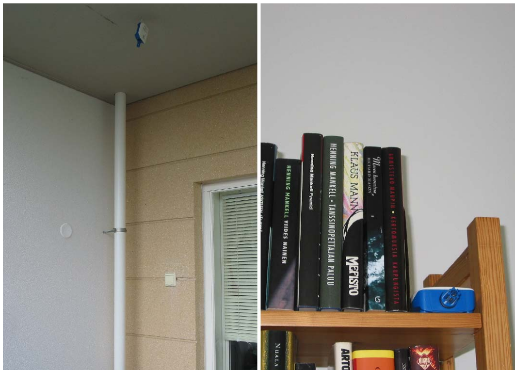
Kuva 4.10. Esimerkkejä dataloggerien sijoittamisesta parvekkeelle ja huoneistoon. Asennuksessa pyrittiin välttämään mekaanista kiinnitystä.
