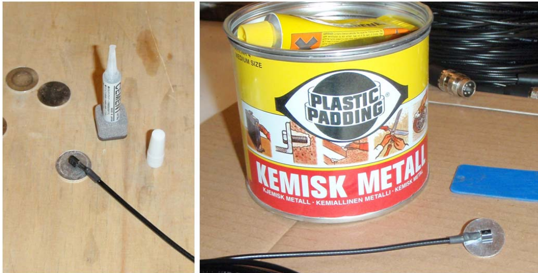
Kuva 4.7. Puolijohdeanturi lyhytaikainen kiinnittyminen alumiinilevyyn varmistettiin pikaliimalla ja pitkäaikainen kiinnittyminen spakkelilla.
