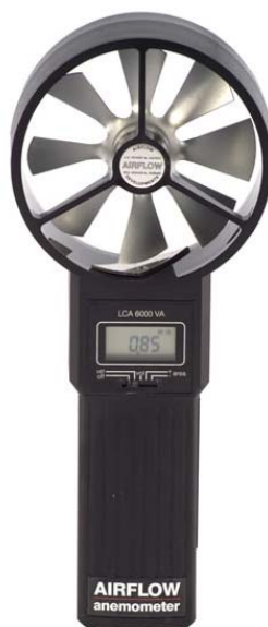
Kuva 4.11. Huoneiston ilmanvaihtuvuuden määrittämisessä käytetty Airflow LCA 6000 VA – siipipyöräänemometri.
