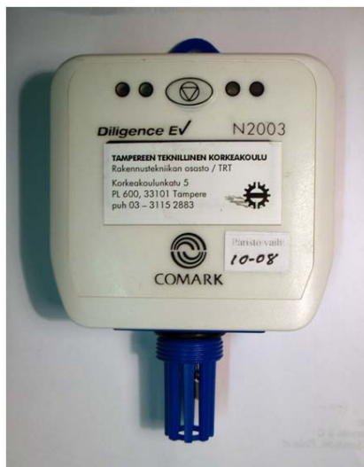
Kuva 4.4. Ilman lämpötilaa ja suhteellista kosteutta mitattiin yhteensä 23 parvekkeelta ja huoneistosta tallentavilla paristokäyttöisillä dataloggereilla.
