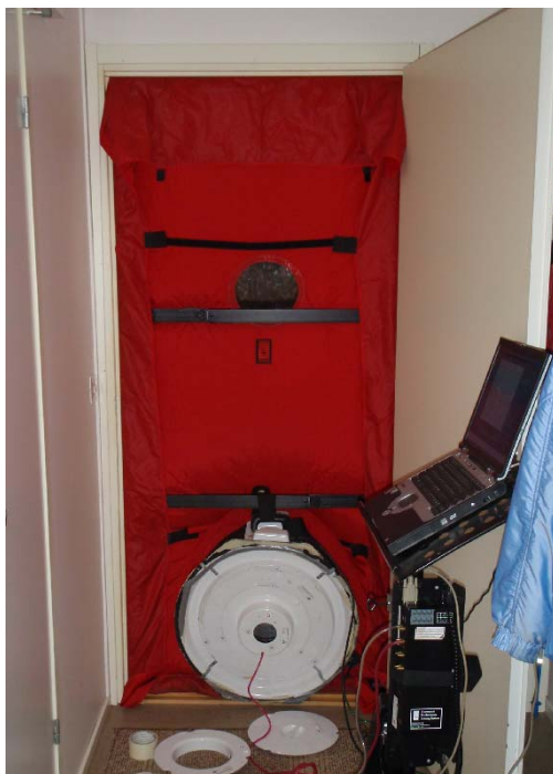
Kuva 4.12. Ilmatiiveys määritettiin The Energy Conservatory:n valmistamalla painekoelaitteistolla.
