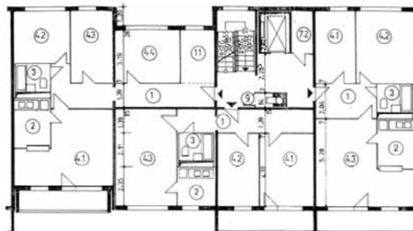
Kuva 8.2. WBS70-elementtijärjestelmän mukaisen asuinkerrostalon tyypillinen pohjaratkaisu [35].
