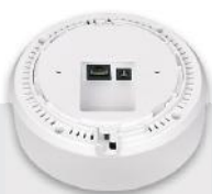
NWA1123-AC Точка доступа 802.11 a/b/g/n/ac с двумя радиомодулями и поддержкой PoE, предназначенная для крепления на потолке
