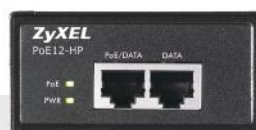
PoE12-HP 1-портовый инжектор питания PoE для Gigabit Ethernet
