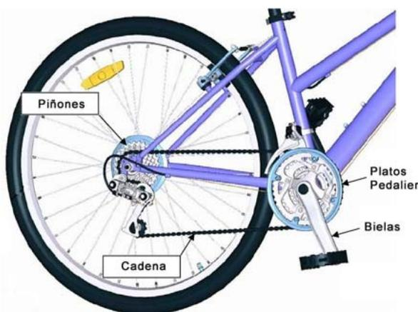
En todo mecanismo resulta indispensable un **elemento motriz (entrada)** que origine el movimiento gracias a una **fuerza motriz** (que puede ser un muelle, una corriente de agua, nuestros músculos, un motor eléctrico...). El movimiento originado por el motor se **transforma** y/o **transmite** a través de los mecanismos a los **elementos conducidos (salida)** (ruedas, brazos mecánicos...) realizando, así, el trabajo para el que fueron construidos.
