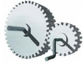
**31.** Un motor que gira a 100 r.p.m. tiene montado en su eje un engranaje de 60 dientes y está acoplado a otro engranaje de 20 dientes.
