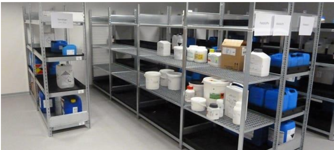
Ilustrativní obrázek uložení obalů v záchytných vanách u regálového skladování
