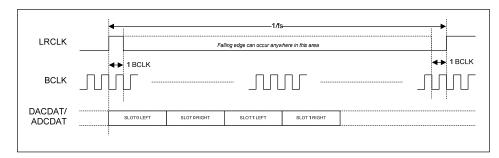
Figure 55 TDM in DSP Mode B
