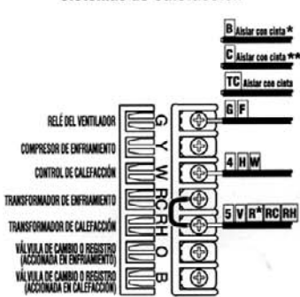
Sistemas de Calefacción
