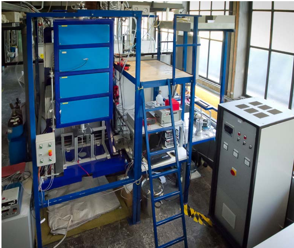
Abbildung 23: Foto des neuen Hochtemperatur-Versuchsstandes, wie er für Arbeitspaket 5 zum Einsatz kam (Setup im Bereich des 4-Zonen-Hochtemperaturofens entspricht weitgehend Arbeitspaket 4).
