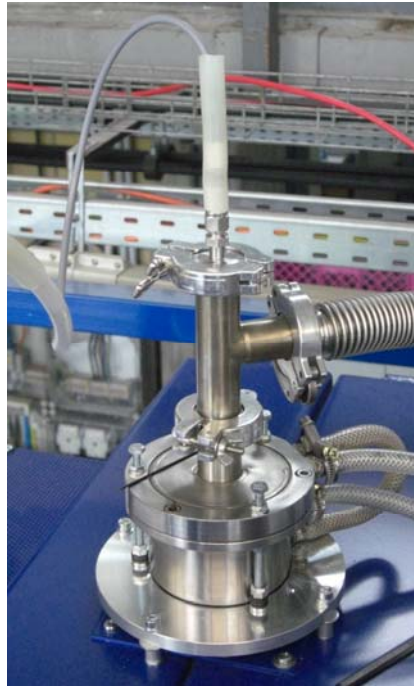
Abbildung 14: Befestigung des oberen Kühlflansches mit 3 Einstellschrauben. Zusätzlich ist rechts ein Kompensator zu erkennen, mit dem der Flansch von den weiteren Aerosol führenden Bauteilen mechanisch weitgehend entkoppelt wird.
