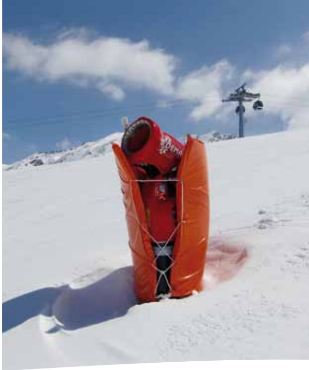
Tekniske installasjoner i nedfartene må polstres forsvarlig.
