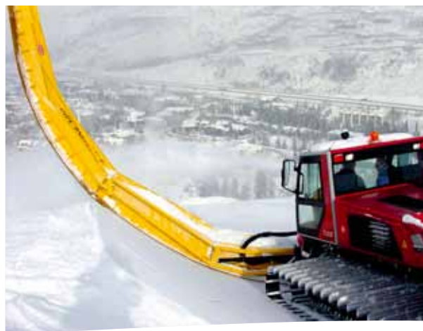
Pipefres leveres i ulike størrelser og er nødvendige for godt vedlikehold av en halfpipe.
