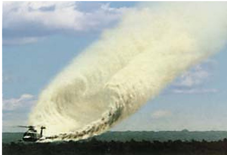
Abbildung 5: Nachlaufturbulenz eines Helikopters im Vorwärtsflug (Quelle: Defence Force , Neuseeland).
