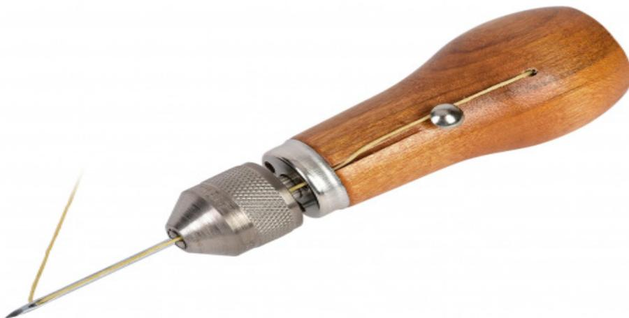
Mit dieser Hand Nähmaschine kann man auch ohne Strom alles reparieren, wenn auch mühselig. Die Nadel wird durch das Material gesteckt, ca. 2-3 mm herausgezogen, es bildet sich bei der kurzen Rille eine Ausbuchtung, durch die man dann einen zweiten Faden steckt. Danach stramm ziehen, so dass sich die Verknotung in der Mitte des Materials bildet. Das ist auch das Grundprinzip einer Nähmaschine. Als Garn verwende ich gewachstes Takelgarn.
